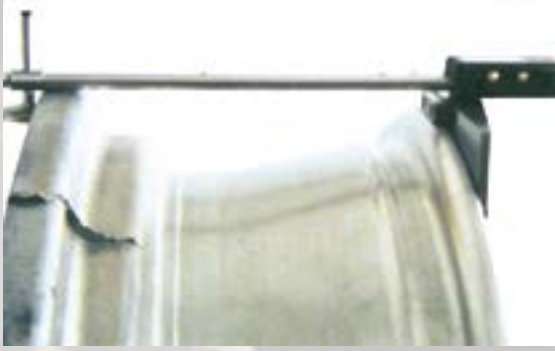
Ham döküm tekerlek ve işlenmiş jant flanşı boyunca yapılan ölçüm
