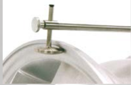
İç jant flanşına düzlem paralelliğini kontrol etme
